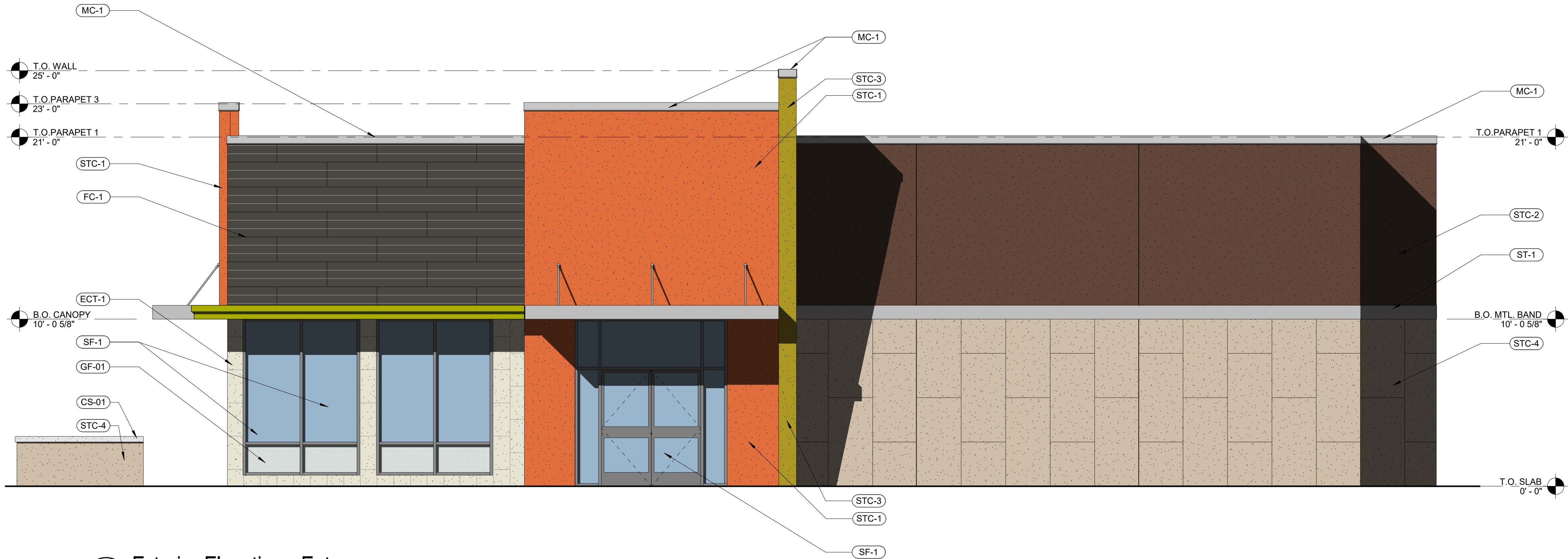
02 Exterior Elevation - Entry SCALE: 1/4" = 1'-0"
