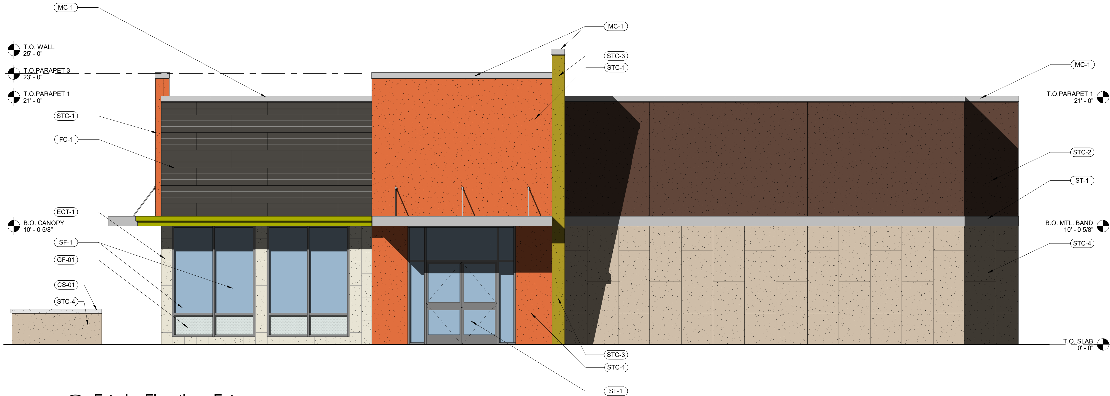
02 Exterior Elevation - Entry SCALE: 1/4" = 1'-0"
